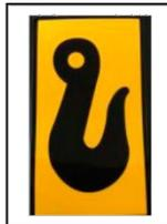
La fixation avec une élingue doit s'effectuer si le déchaumeur à disques est soulevé avec une grue ou un chariot élévateur. 4 points.
