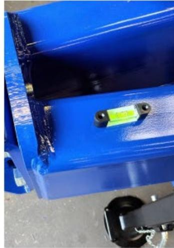
Le déchaumeur peut être ajusté avec le niveau à bulle quand il est monté sur un tracteur et que l'ensemble se trouve sur une surface horizontale.
