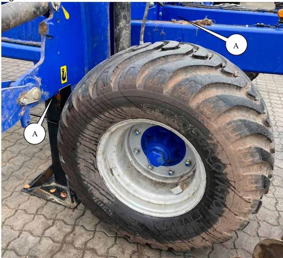
Démontez les écrous de roue, et la roue peut être remplacée. Après avoir installé une nouvelle roue, vissez les écrous et serrez « à la main ». Abaissez ensuite les roues pour qu'elles touchent le sol et serrez les écrous à 300 Nm.
