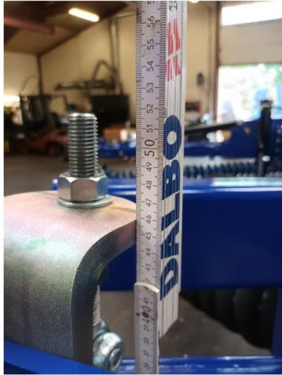
Longeur du fuseau de roue de support C-C = 505 mm
