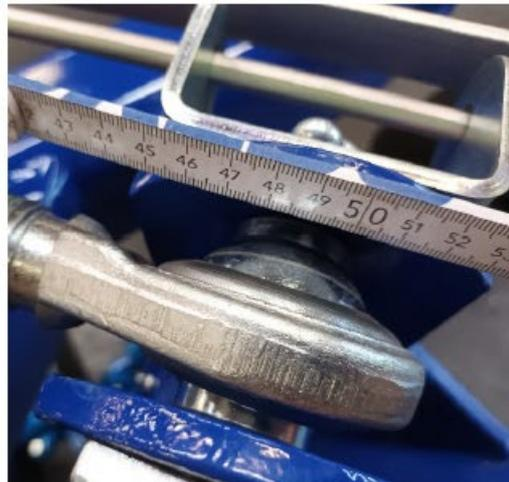
Le longeur du fuseau doit être pareil des deux côtés.
