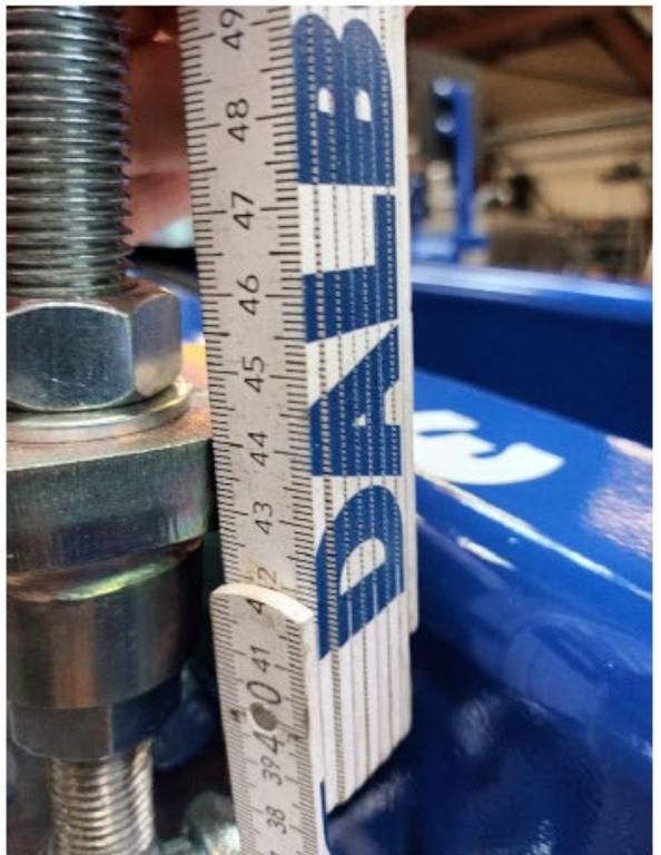
Point de mesure 4 – Chaîne arrière droit 460 mm
