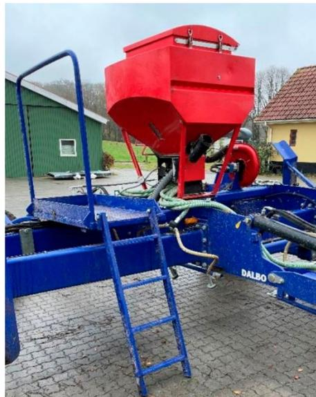
Pour accéder à la plate-forme (A), dépliez complètement la machine et abaissez-la en position de travail avec le châssis à roues avant de rabattre l'échelle (B).
