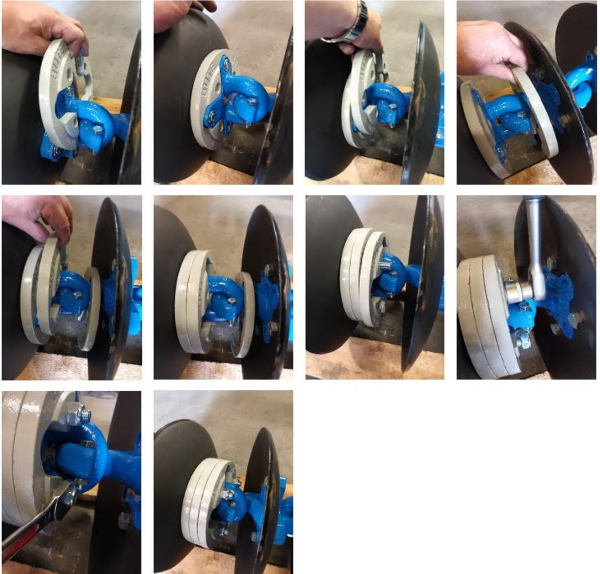
Dans certain cas l'écrou de boulon de blocage ne peut que être serré avec un clés mixte (plate).
