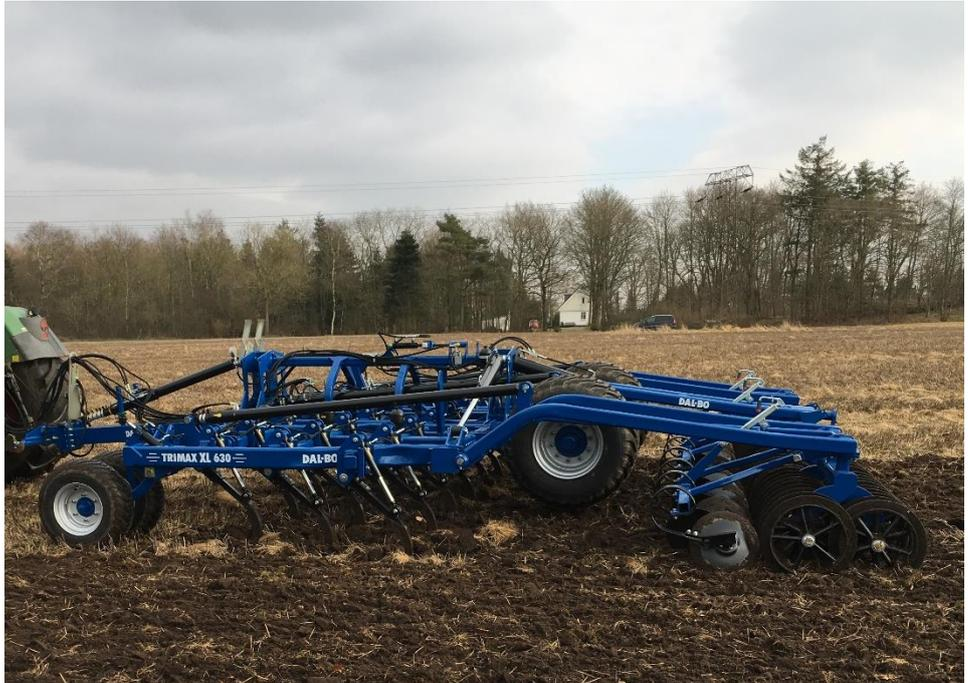
TRIMAX tracté est conçu de telle sorte que vous puissiez obtenir une coupe complète avec un gyrobroyeur, permettant de stopper la croissance à la fois des cultures et des mauvaises herbes. La forme des dents est telle que la terre végétale et les résidus de plantes sont projetés en l'air et mélangés en une masse homogène.
