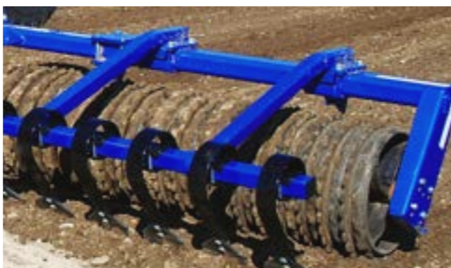
Monteret med hydraulisk justerbar lamelplanke.
