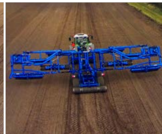
2. Sidesektioner klappes ud og sænkes til jorden.
