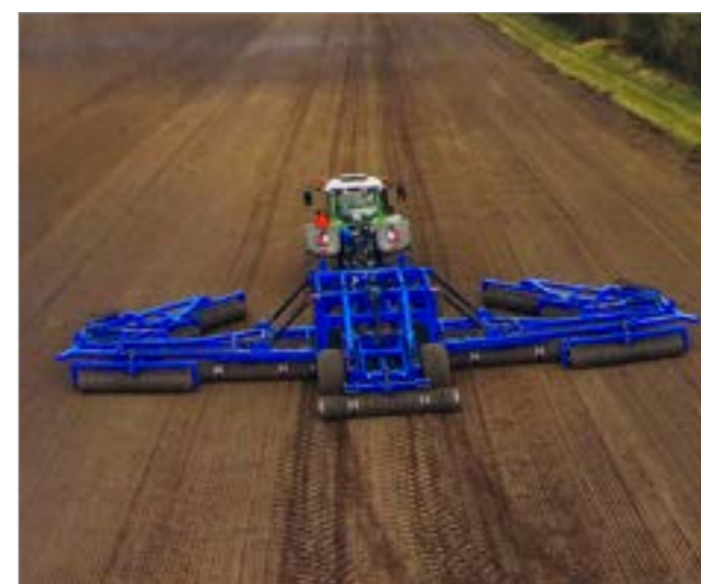
3. Når tromlesektionerne er sænket til jorden, rulles de yderste sidesektioner ud til arbejdsposition.
