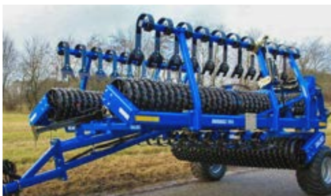
Monteret med lamelplanke. Her vist i transportstilling.
