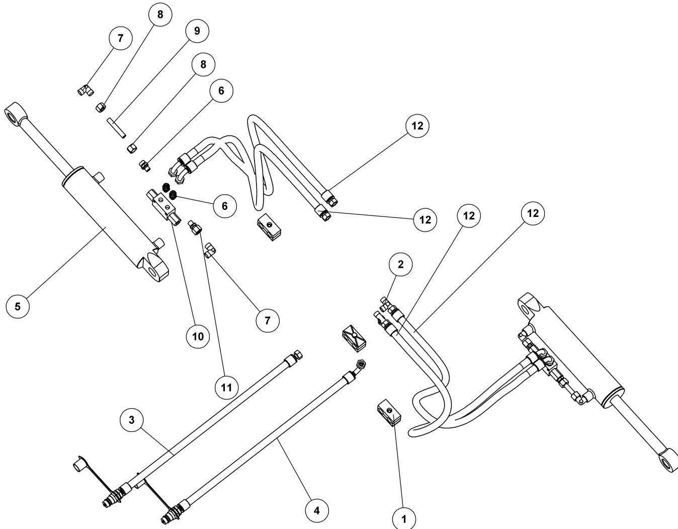
**HYDRAULIK TIL VINKELJUSTERING**
