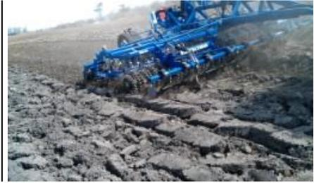
Das Crackerboard soll **nicht** als Planierschild wirken, sondern eine leichte Bearbeitung der Erde ermöglichen. Da sich jeder Zinken individuell bewegen kann, und damit örtlichen Hindernissen nachgibt, ist das Crackerboard leicht zu bedienen und erfordert im Vergleich zu einer Planierschiene weniger Justierung.
