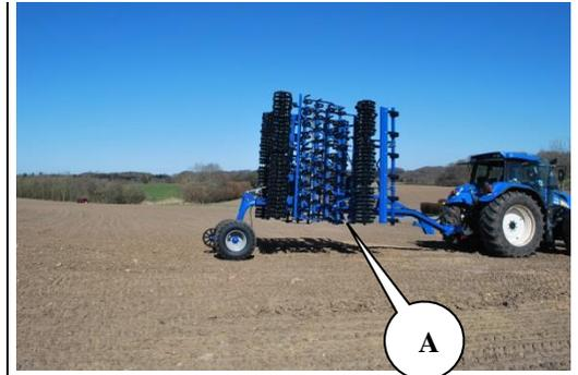
Um die Höhe des Schwerpunkts der Maschine zu minimieren sowie ein stabiles Transport zu erreichen, kann die Maschine mithilfe des Radgestells (A) (gelb gekennzeichnet) abgesenkt werden. Die Maschine wird abgesenkt, bis die Höhe unter der unteren Rahmenteil (B) etwa 20 cm beträgt.
