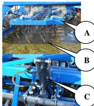
1. Die Schläuche werden vom Zylinder abmontiert.
