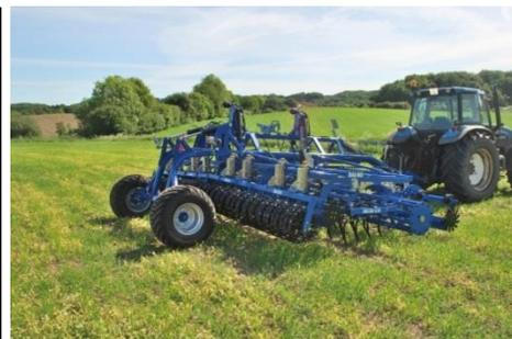
Das Radgestell (gelb gekennzeichnet) wird aktiviert und die Räder werden vom Boden angehoben. Der Zylinder für das Aus- und Zusammenklappen (rot gekennzeichnet) wird bis zum erforderlichen Arbeitsdruck am Manometer aktiviert und in Schwimmstellung gebracht.
