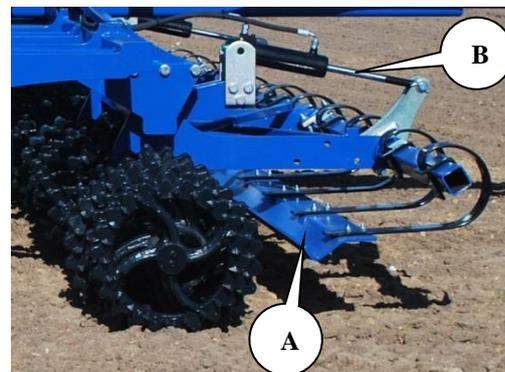
1. Die Schläuche werden vom Zylinder abmontiert.
