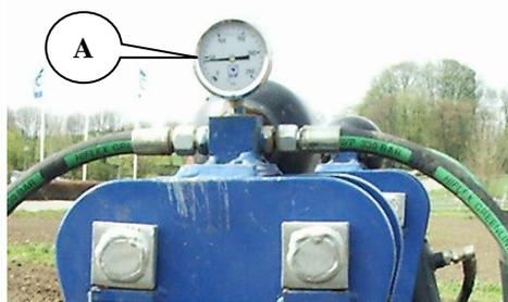
2. Die Zylinder werden danach in die Fließstellung gebracht. Die Fließstellung ist für die hydraulische Gewichtsüberführung notwendig, wo die Seiten individuell beweglich sind.
