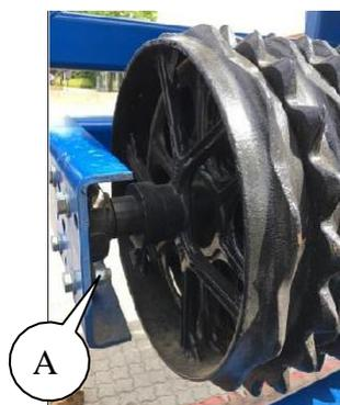
Si vous n'avez pas de grue à disposition, vous pouvez activer doucement la répartition des poids de la MEGAROLL et la placer en position pour que les boulons soient lâches et puissent être retirés.
