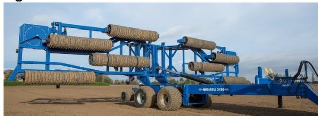
5. Actionnez les cylindres pour déplier et plier les châssis latéraux les plus à l'intérieur et pliez les sections latérales vers l'intérieur (tuyau marqué en rouge).
