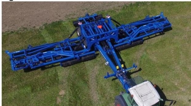
4. Actionnez les cylindres pour déplier et plier les châssis latéraux les plus à l'extérieur et dépliez totalement les sections latérales (tuyau marqué en blanc → activé par l'interrupteur 4).
