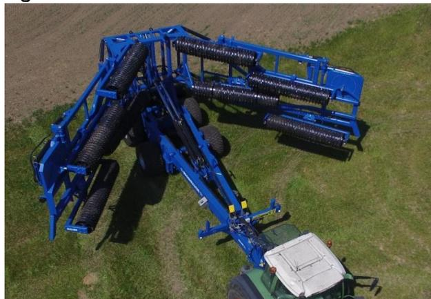
6. Abaissez les sections latérales dans le verrou de transport (A) avec le cylindre d'inclinaison (tuyau marqué en blanc → activé par l'interrupteur 2) Vérifiez que les sections latérales soient entièrement insérées dans le verrou de transport.
