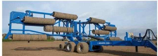
3. Actionnez le cylindre d'inclinaison et abaissez le rouleau jusqu'au sol (tuyau marqué en blanc → activé par l'interrupteur 2).
