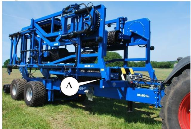
2. Actionnez les cylindres pour déplier et plier les châssis latéraux les plus à l'intérieur et déployez les sections latérales (tuyau marqué en rouge).
