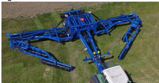
5. Actionnez le cylindre pour abaisser la section de rouleau arrière/médiane et posez la section au sol (tuyau marqué en blanc → activé par l'interrupteur 3).
