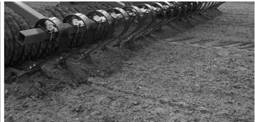
Die Lamellenschiene ist jedoch **nicht** für die Nutzung als Dozerblatt vorgesehen, sondern soll bei der leichten Bearbeitung des Bodens zum Einsatz kommen. Da sich jeder Zinken individuell bewegen lässt und so lokalen Widerständen weichen kann, ist das Fahren mit der Lamellenschiene einfach.
