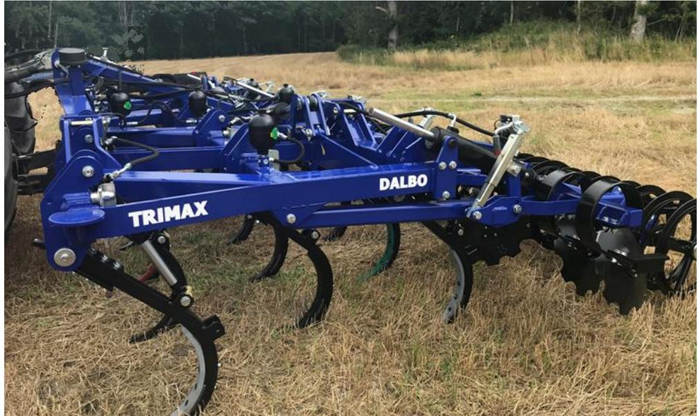
TRIMAX ist so konzipiert, dass ein vollständiger Schnitt erreicht werden kann, wodurch das Wachstum von Pflanzen und Unkraut unterbrochen wird. Durch die Ausführung der Zinken werden Boden- und Pflanzenreste in die Luft geschleudert und zu einer homogenen Masse vermischt.
