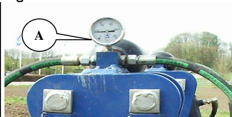
2. Amener les vérins en position de flottement. Cette position est nécessaire pour obtenir un transfert de poids hydraulique où les sections bougent individuellement.
