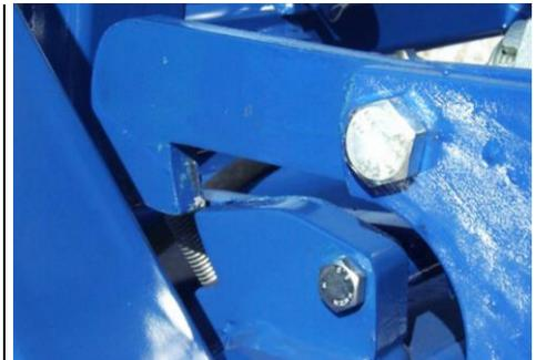
Fixation pour le transport pour le châssis
