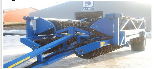
5. Abaissez les éléments latéraux dans les crochets de transport avec les vérins de basculement marqués en blanc. Lorsque les crochets de transport sont engrenés, mettez les tuyaux marqués en blanc en position flottante !
