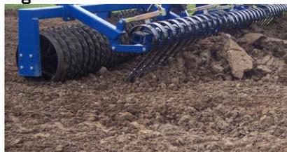
Sa fonction n'est **pas** celle d'une lame de terrassement, mais bien de décomposer le sol. Comme chaque dent peut bouger individuellement et céder ainsi à la pression locale, la crackerboard est facile à utiliser et exige peu d'ajustement comparé à une barre de nivelage.
