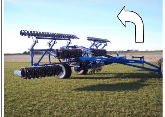
3. Activer les vérins extension/rétraction pour replier les sections latérales.
