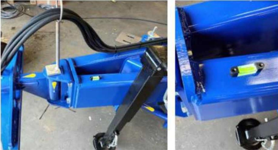
Wenn sich ein Zugfahrzeug samt Egge auf einer horizontalen Fläche befindet, kann er mit der Wasserwaage höher eingestellt werden.
