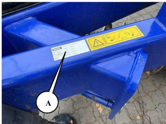
An der Scheibenegge befindet sich ein Typenschild. Nachfolgend finden Sie ein typisches Typenschild, das die folgenden Daten umfasst:
