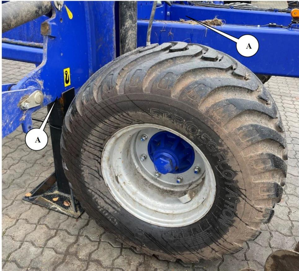
Die Radmuttern entfernen, wonach das Rad gewechselt werden kann. Nach dem Montieren eines neuen Rads die Muttern anschrauben und mit „fester Hand“ anziehen. Danach die Räder so absenken, dass sie Halt auf dem Untergrund haben. Die Muttern auf 300 Nm anziehen.
