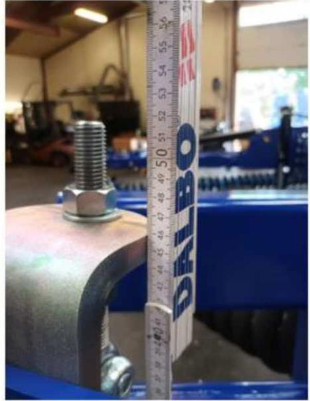
Spindellänge Stützräder C-C = 505 mm
