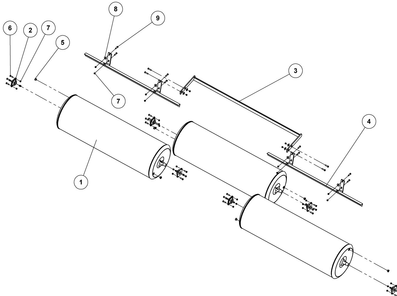
**SÆT STÅLTROMLE PÅ AKSEL (Ø711,2 MM)
