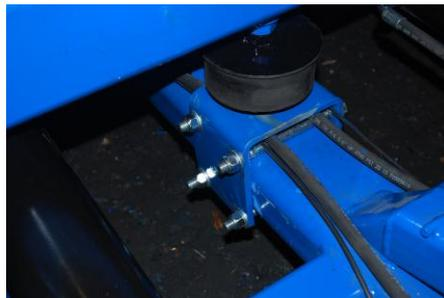
Inclinez le rouleau vers le bas avec les grands vérins jusqu'à ce que le boulon d'ajustement sur la section centrale touche la lame de ressort montée sur la barre d'attelage. Il peut être nécessaire d'ajuster le boulon, selon la barre d'attelage du tracteur.
