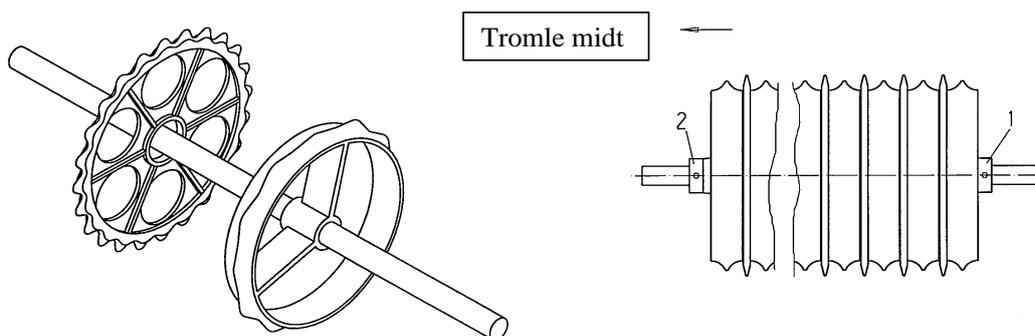
**Anneaux Crosskill.** Notez le sens de rotation de l'arbre. Après l'anneau de butée extérieur (fig. 8, pos. 1), commencez avec un petit anneau. Il doit être monté comme sur la figure 8.
