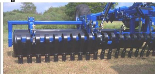
Il se peut que les sections du dispositif ne travaillent pas en même profondeur, pour régler ceci, il peut être nécessaire de "remettre à zéro" le dispositif en le levant au maximum.
