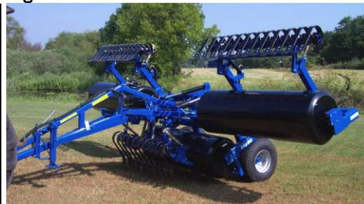
3. Activer les vérins de dépliage et de pliage à nouveau et plier les sections latérales (les vérins de pliage/dépliage doivent être complètement rassemblés)
