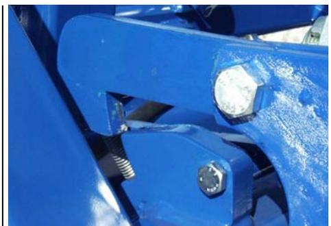
Fixation pour le transport pour le châssis
