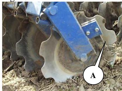
Les raclages des disques peuvent/doivent être réglés de manière à ce qu'il n'y ait que 3 à 5 mm d'air entre disque et raclage.
