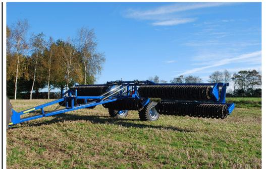
4. Das Aus- und Zusammenklappen der Zylinder für die inneren Seitenrahmen, markiert: Rot, wird erneut aktiviert und diese Seitenteile werden ganz zusammengeklappt.
