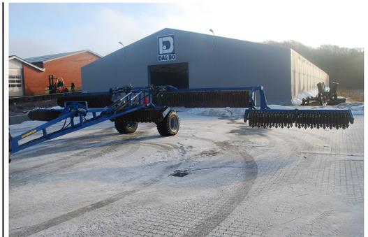
3. Das Aus- und Zusammenklappen der Zylinder für die äußeren Seitenrahmen, markiert: Schwarz, wird erneut aktiviert und diese Seitenteile werden ganz zusammengeklappt.
