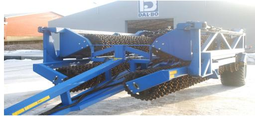
5. Die Seitenrahmen werden nun mit den Kippzylindern, markiert: Weiß, auf die Transporthaken abgesenkt. Wenn die Transporthaken eingerastet sind, werden die Weiß gekennzeichneten Schläuche in Schwimmstellung gebracht!
