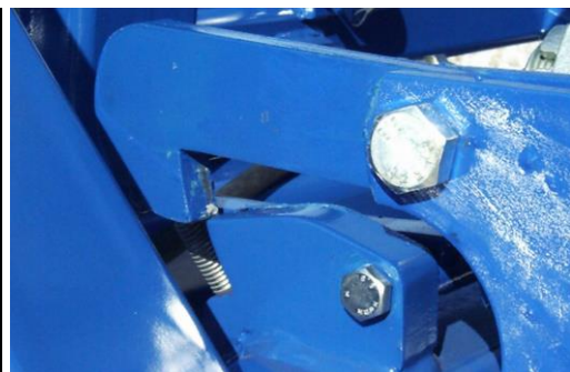
Transportsicherung am Hauptgestell
