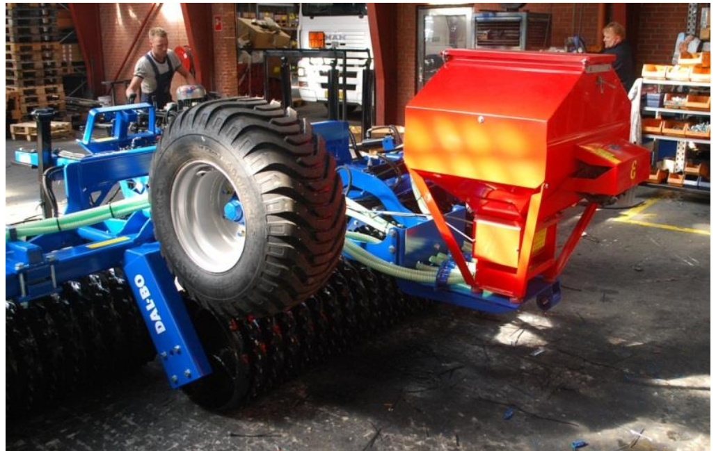
Die P-Box Speed wird in Arbeitsstellung an der MINIMAX 630 montiert.
