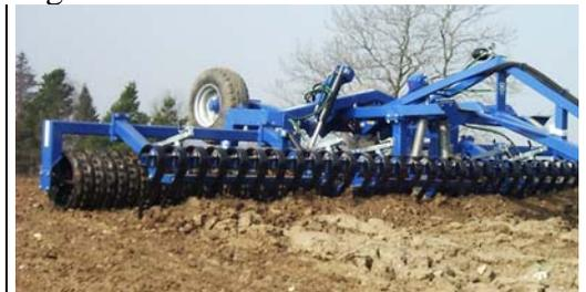
Es ist jedoch **nicht** beabsichtigt, dass das Crackerboard als "Planierraupe" benutzt werden soll, sondern nur für die leichte Bearbeitung der Erde. Da sich jeder Zahn individuell bewegen, und damit bei lokalen Widerständen nachgeben kann, ist es sehr einfach mit dem Crackerboard zu fahren. Weiterhin erfordert das Crackerboard weniger Regulierung als eine Planierschiene während der Fahrt.
