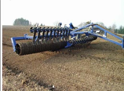
3. Die Zylinder für das Aus- und Zusammenklappen werden wieder aktiviert, und die Seitensektionen werden eingeklappt. (Aus- und Zusammenklappzylinder müssen ganz zusammen gezogen sein.). Der Kippzylinder wird aktiviert und die Walze wird in die Transportschalen gesenkt.
