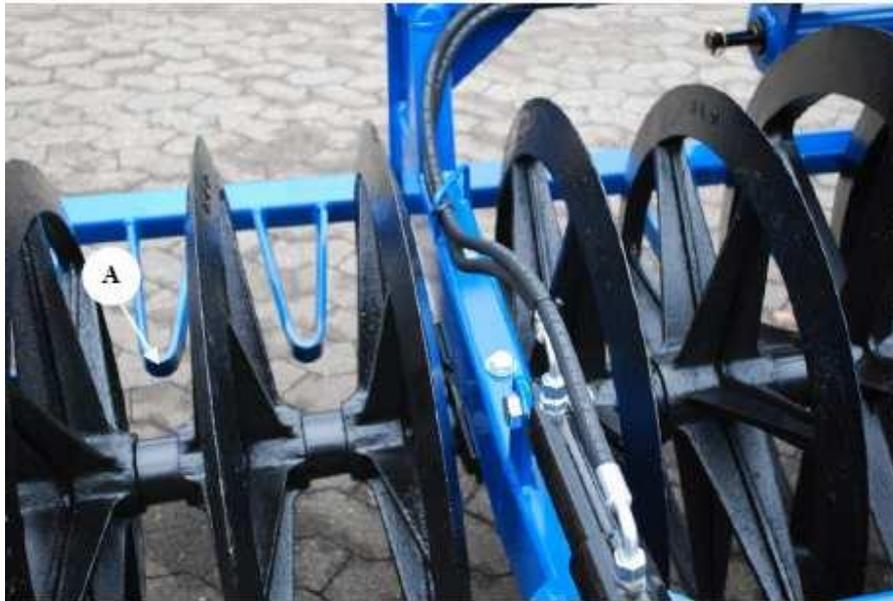
Cependant, des dispositifs de raclage ne sont pas montés sur le LEVELFLEX avec les disques crosskill, car ces disques se nettoient automatiquement.
