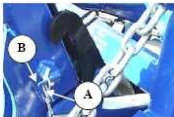
Le déclenchement de la fixation transport se fait, de façon sûre, du tracteur en activant la poignée hydraulique des sections latérales et en pressant les sections latérales jusqu'à la position supérieure maximale. Ainsi, le crochet est déclenché et les sections latérales peuvent être abaissées. En même temps que les sections latérales s'abaissent, la boucle (A) glisse du cliquet (B) et le crochet (C) sera de nouveau prêt à fixer les sections latérales en position de transport.
