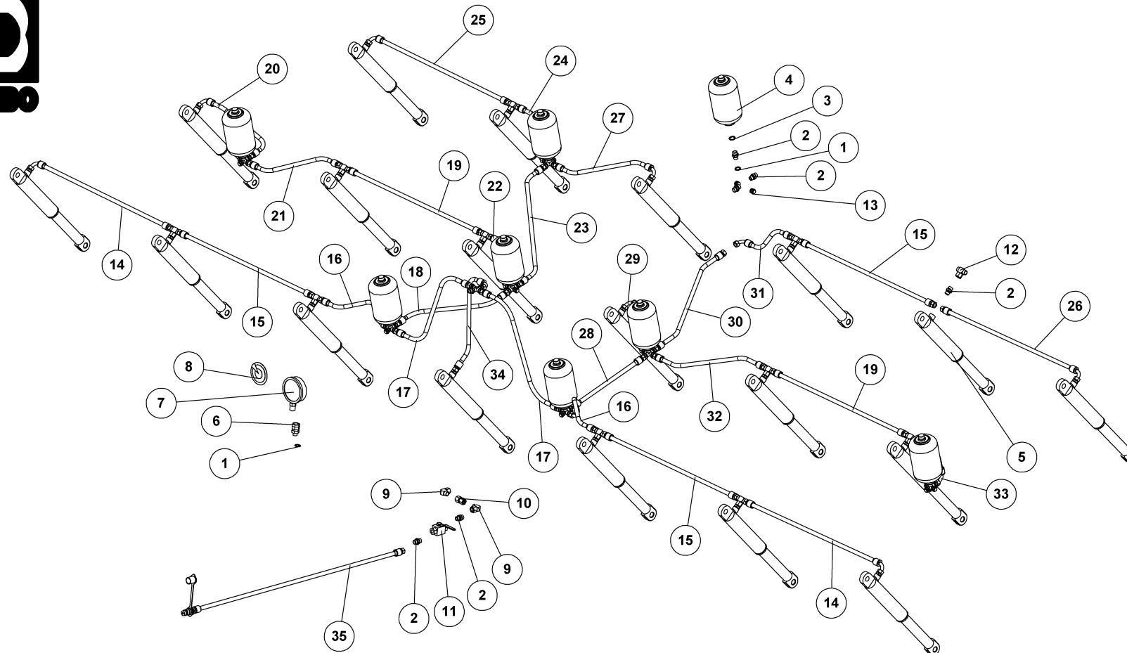
**HYDRAULIK FOR STENSIKRING
