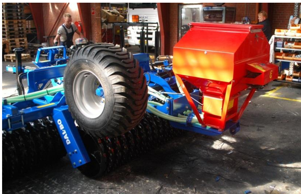
P-box speed monté sur le MINIMAX 630 en position de travail.
