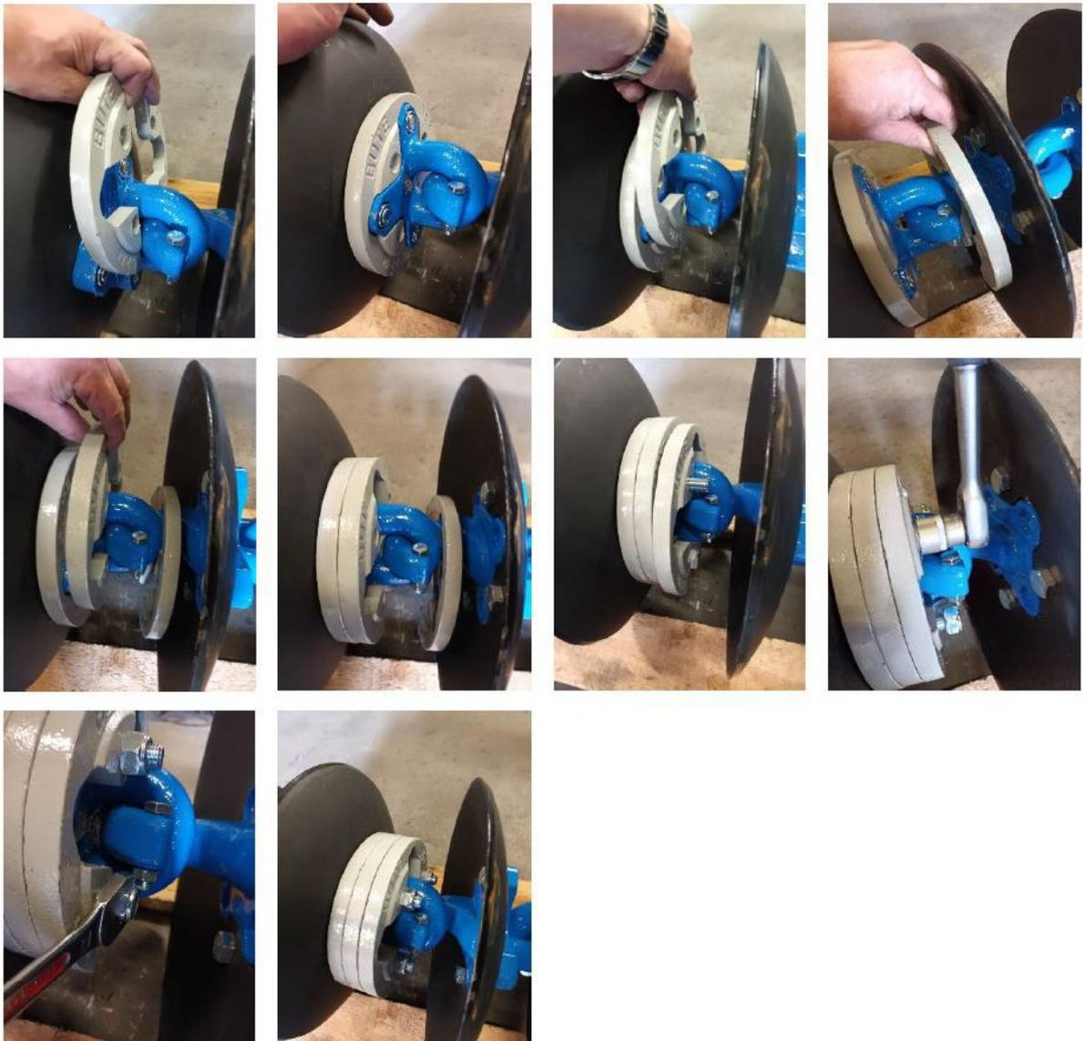
In manchen Fällen kann die Mutter an der Sicherungsschraube mit einem Schraubenschlüssel angezogen werden.
