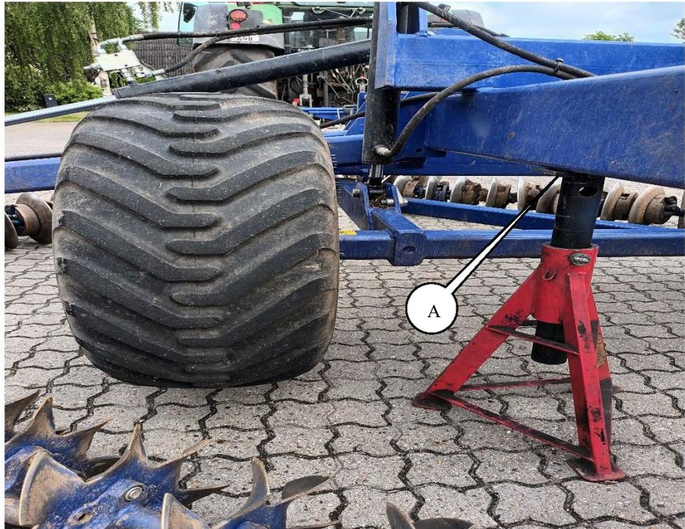
Die Radmuttern entfernen, wonach das Rad gewechselt werden kann. Nach dem Montieren eines neuen Rads die Muttern anschrauben und mit „fester Hand“ anziehen. Danach das Rad so absenken, dass es Halt auf dem Untergrund hat. Die Muttern auf 300 Nm anziehen.
