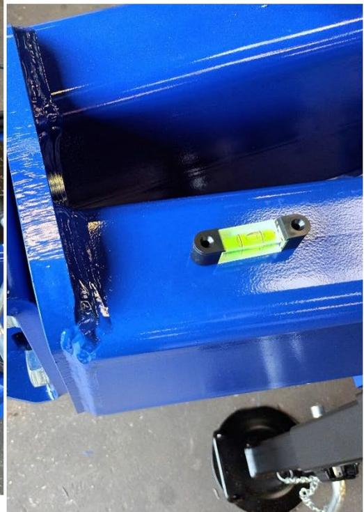
Wenn sich ein Zugfahrzeug samt Egge auf einer horizontalen Fläche befindet, kann er mit der Wasserwaage höher eingestellt werden.
