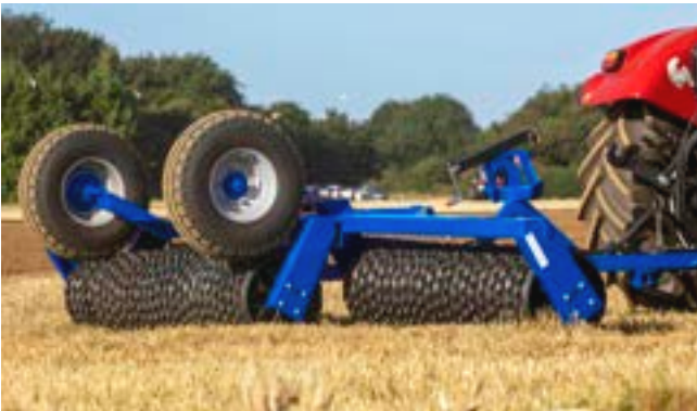
3 Les sections de rouleau sont abaissées en position de travail et les roues sont automatiquement soulevées pour être dégagées.
