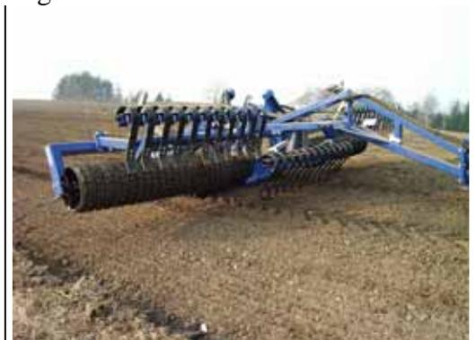
3. Die Zylinder für das Aus- und Zusammenklappen werden wieder aktiviert, und die Seitensektionen werden eingeklappt. (Aus- und Zusammenklappzylinder müssen ganz zusammen gezogen sein.). Der Kippzylinder wird aktiviert und die Walze wird in die Transportschalen gesenkt.
