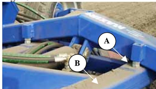
Ist die Mittelsektion nicht parallel zum Untergrund, müssen die Bolzen (A, Figur 5) reguliert werden.
