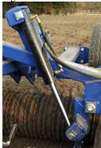
5. Sichern Sie sich, dass der Bolzen in Bolzenstopp einrastet, und sichern Sie die Bolzen mit Splinte.
