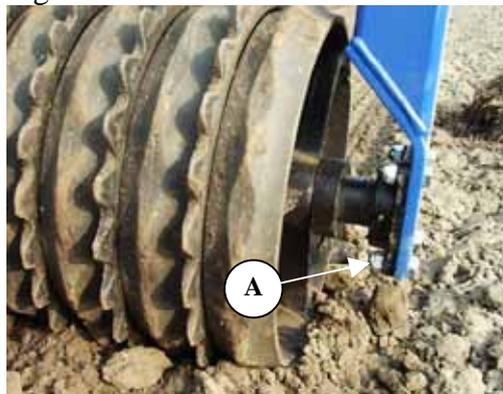
Falls kein Kran zur Verfügung steht, kann die Gewichtsüberführung des Maxirolls evt. leicht aktiviert, und in eine Position gestellt werden, wo die Bolzen locker sind, und demontiert werden können.
