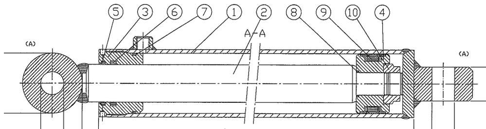
1. Das Öl wird aus dem Zylinder abgelassen, indem der Kolben vorsichtig vor und zurück gefahren wird.
