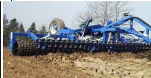
Es ist jedoch **nicht** beabsichtigt, dass das Crackerboard als "Planierraupe" benutzt werden soll, sondern nur für die leichte Bearbeitung der Erde. Da sich jeder Zahn individuell bewegen, und damit bei lokalen Widerständen nachgeben kann, ist es sehr einfach mit dem Crackerboard zu fahren. Weiterhin erfordert das Crackerboard weniger Regulierung als eine Planierschiene während der Fahrt.
