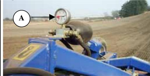
3. Der Zylinder wird danach in die Schwimmstellung gebracht. Die Schwimmstellung ist notwendig, um die hydraulische Gewichtsüberführung erreichen zu können. Hierbei sind die Seitensektionen individuell bewegbar.
