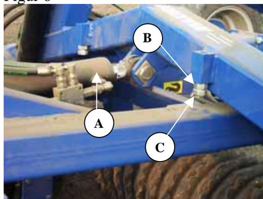
Für die Einstellung ist ein Pendel (A) an der Mittelsektion installiert, das mit dem feststehenden Teil fluchten muss.
