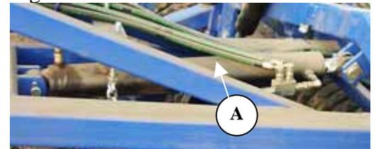
1. Die Schläuche am Zylinder werden demontiert.
