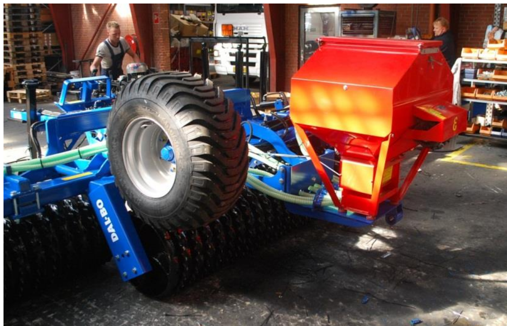
P-box speed monteret på MINIMAX 630 i arbejdsstilling.
