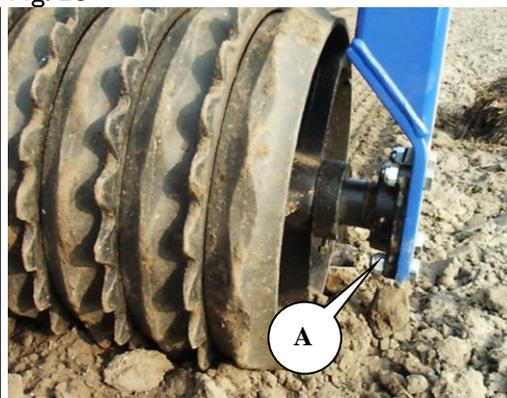
Si vous ne disposez pas de grue, une solution envisageable serait d'enclencher éventuellement le système de transfert de poids du POWERROLL dans une position permettant aux boulons de se desserrer et d'être démontés.
