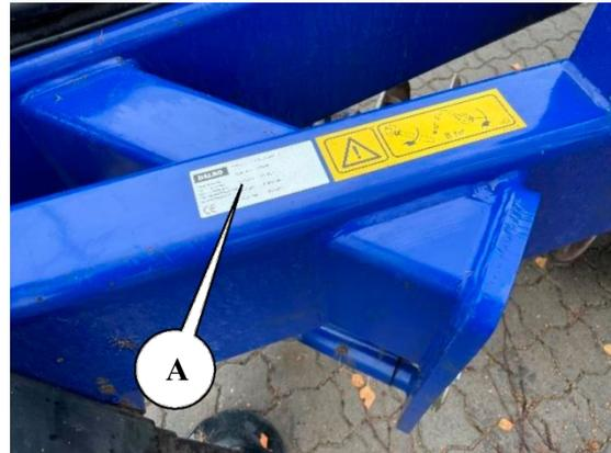
Die Telleregge verfügt über ein Typenschild. Nachfolgend finden Sie ein gängiges Typenschild, das die folgenden Daten umfasst:
