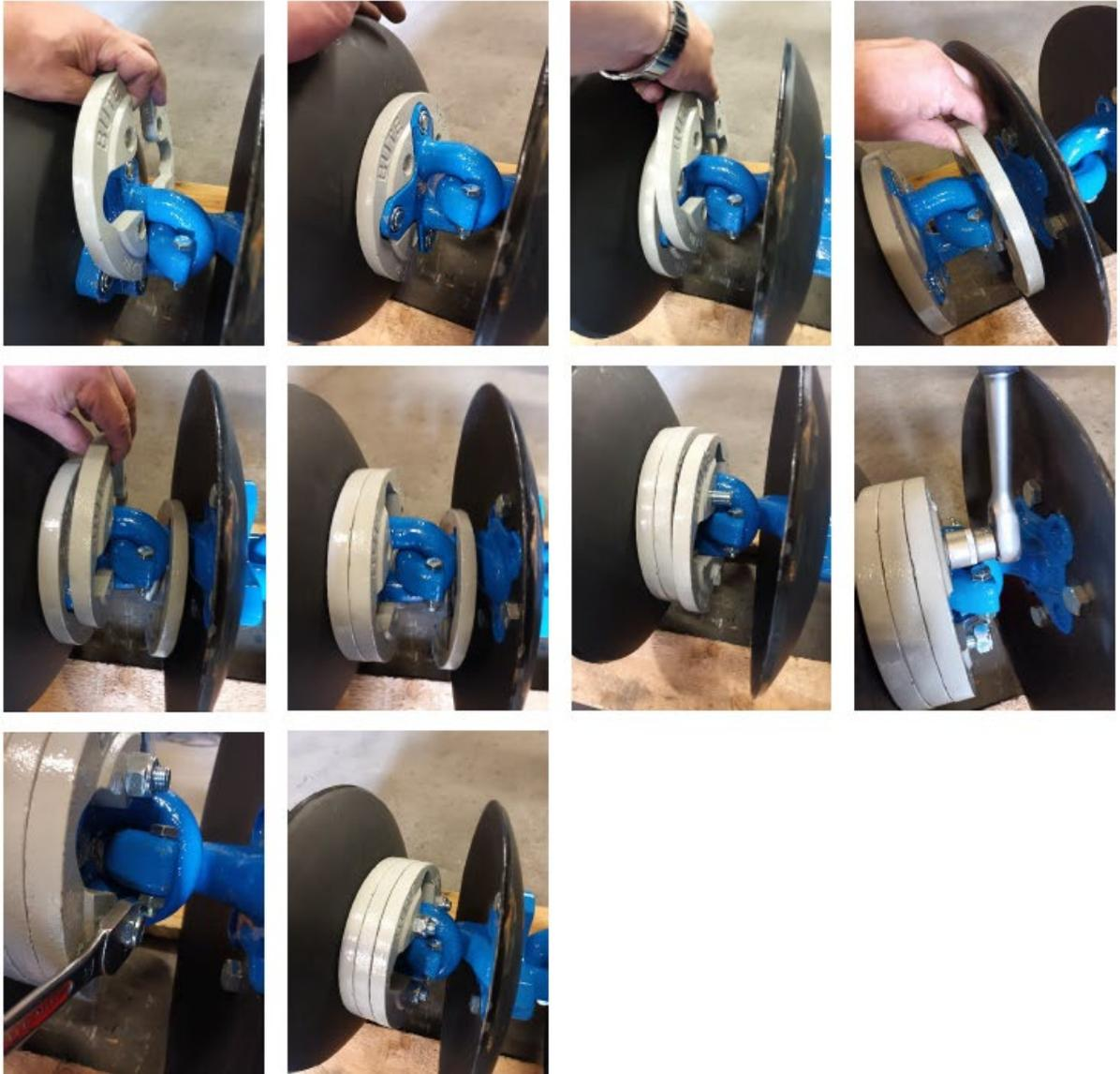
Teilweise lässt sich die Mutter am Verriegelungsbolzen nur mit einem Gabelschlüssel anziehen.
