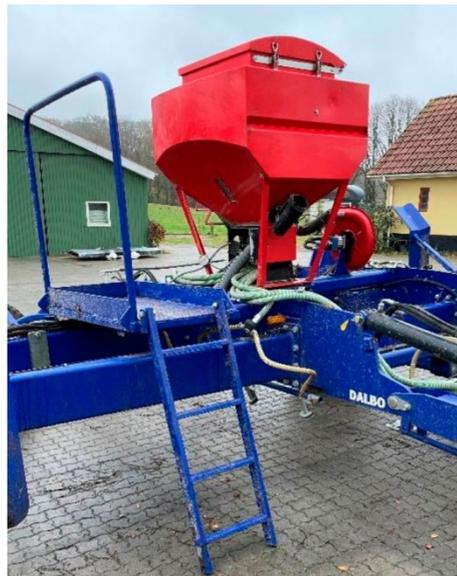
Um Zugang zur Plattform (A) zu erhalten, wird die Maschine vollständig hochgeklappt und mit dem Radgestell in die Arbeitsposition abgesenkt, bevor die Leiter (B) heruntergeklappt wird.
