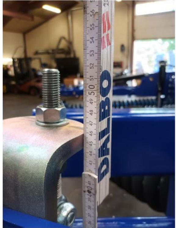
Spindellänge Stützräder C-C = 505 mm
