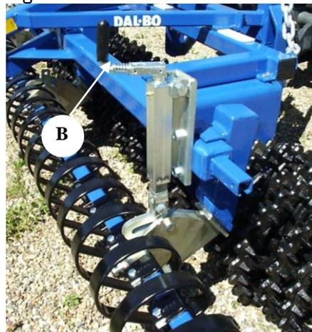
Falls während der Fahrt über dem Feld plötzlich ein Hügel vor der Lamellenplanke aufgebaut wird, kann der Lift ein wenig angehoben werden. Jedoch nur soweit, bis die Ketten stramm sind. (Fig. 5, B) Der FRONTFLEX wird hierbei angekippt, da der vorderste feste Punkt angehoben wird. Hierbei entfernen Sie nicht bedeutungsvolles Gewicht des FRONTFLEX, und deshalb bleibt auch die Packung gleich.
