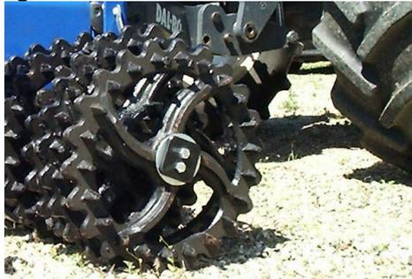
Achten Sie auf die Umlaufrichtung der Trommelringe. Es wird zwischen großen und kleinen Ringen gewechselt. Dichtest am Lager sitzt eine Scheibe und ein kleiner Ring. Denken Sie an die Buchsen unter den großen Ringen. (siehe auch die Einleitung des Abschnittes „Reparatur“)
