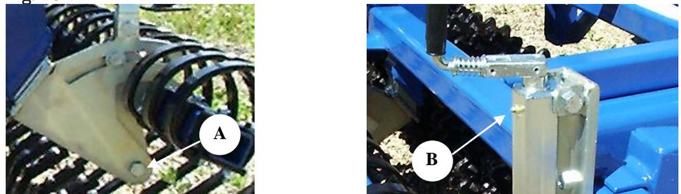
Die Schmiernippel der Spindeln [B] werden jedes halbes Jahr je nach Bedarf geschmiert. Andere Stellen an der Lamellenplanke dürfen nicht geschmiert werden.
