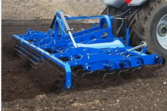
Die CULTILIFT ist auf eine federgehängte Planierschiene vorn aufgebaut, um Unebenheiten auszugleichen und Schollen zu zerkleinern. Die Bearbeitungstiefe der Planierschiene ist über Spindeln mechanisch einstellbar.
