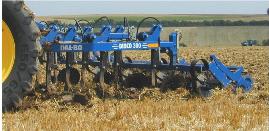
Durch den Überschneit der breiten Flügelschare wird der gesamte Arbeitshorizont durchgeschnitten und Wurzelunkräuter effektiv bekämpft. Die spezielle Form der Schare bewirkt, dass Boden und Pflanzenreste optimal vermischt werden.
