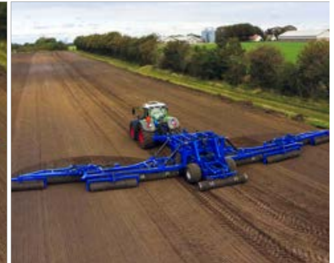
4. Wenn sich die Segmente in der Arbeitsstellung befinden, haben die 2 hydraulischen Gewichtsverteilungssysteme den richtigen Arbeitsdruck und in der Schwebeposition werden die Räder automatisch vom Boden abgehoben.
