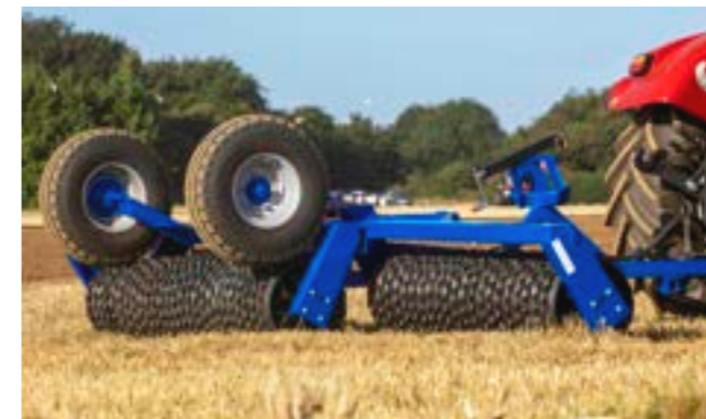
3. Die Walzensegmente werden in die Arbeitsstellung abgesenkt und die Räder werden automatisch angehoben, sodass sie frei drehen.
