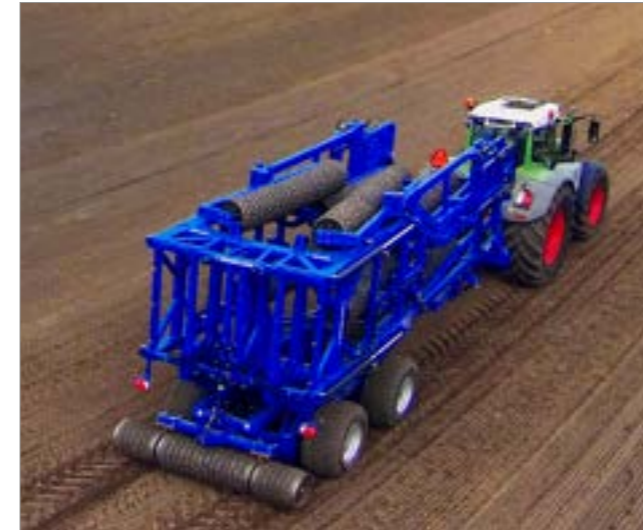
1. Die Segmente werden aus der Transportsicherung gehoben.
