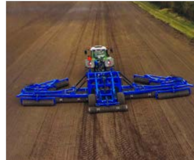
3. Nachdem die Walzensegmente auf den Boden abgesenkt sind, werden die äußeren Seitensegmente in die Arbeitsposition ausgerollt.
